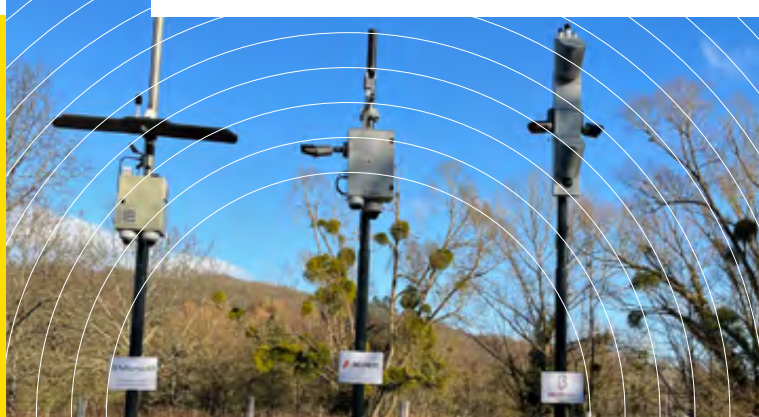
Figure 1 : Les prototypes de radars sonores des trois fabricants sur le site de la RD46 en Vallée de Chevreuse.
